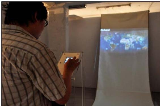
圖1 以ipod touch作為輸入介面，考量現場器材安全，將ipod touch安裝於訂製壓克力座中。
